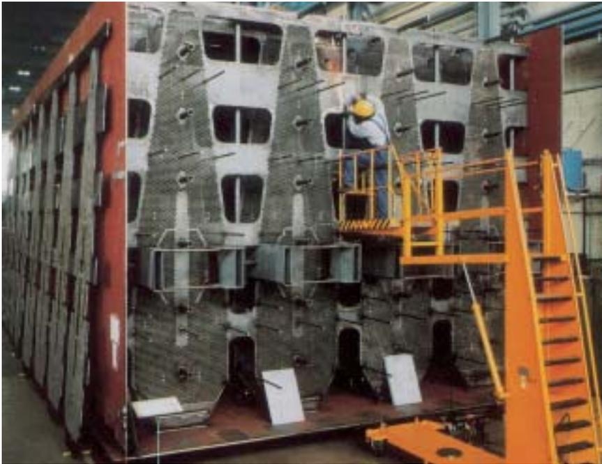
Fig. 9 Modulfertigung eines Turbinenkondensators für das Braunkohlekraftwerk Lippendorf bei ALSTOM in Berlin
